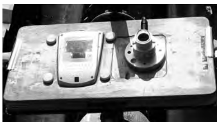
A man çampe solarimetrîs a cele FV, a man drete a termocubie.
